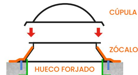
Unir la cúpula al zócalo con las fijaciones ya incluidas en la claraboya **sin apretar los tornillos excesivamente**. De ser necesario, rematar la parte interior con algún remate embellecedor.
